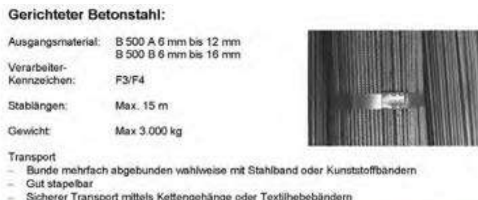
Abb. 67: Übersicht vom gerichteten Betonstahl von FILIGRAN (aus [45])
