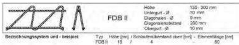
Abb. 66: FILIGRAN-Durchstanzbewehrung (aus [45])
